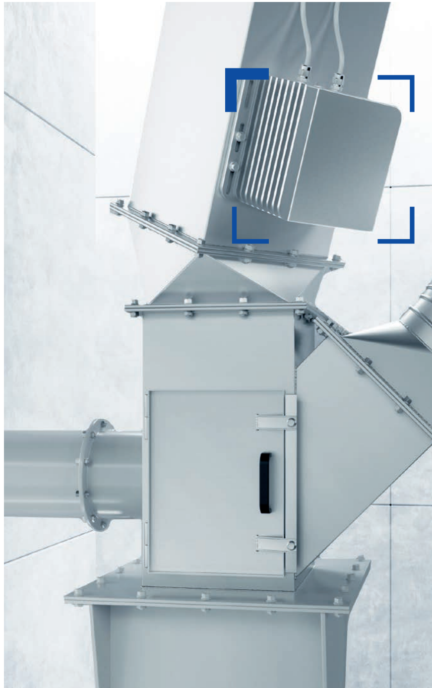
Corona ® extreme in einer Futtermühle unter Verwendung des Powerflansches an einem Fallrohr montiert
